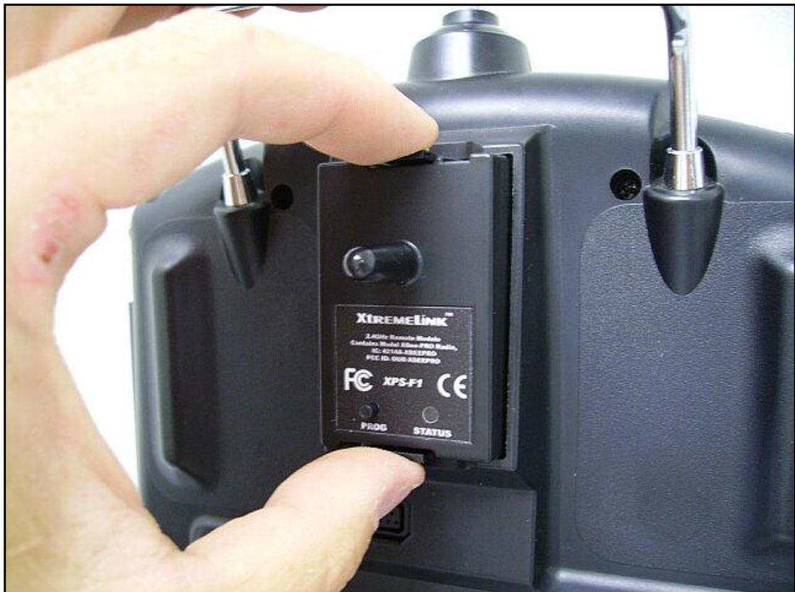
**Figure 3 – Futaba XtremeLink™ module installation**
