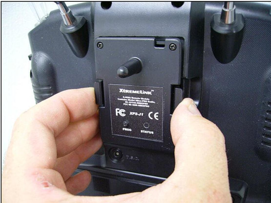
**Figure 4 – JR XtremeLink™ module installation**
